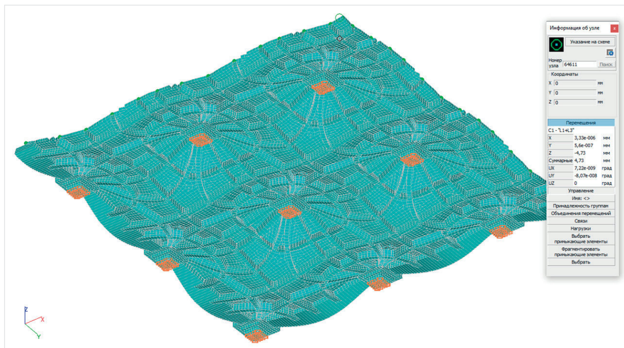
Рис. 1. Конечно-элементная модель покрытия, показана \frac{1}{4} часть. Прогибы середины конструкции от действия полной нормативной нагрузки
