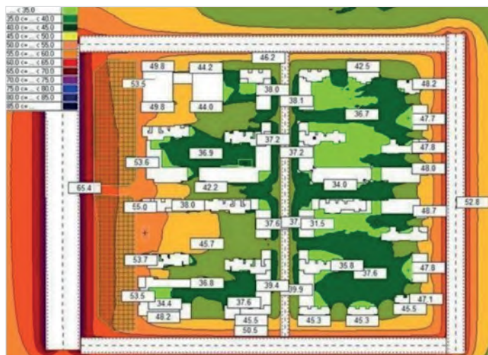
Рис. 10. Карта распределения наружного шума в проекте “Wanda” в Китае в ночное время с использованием программы Cadna/A 11
