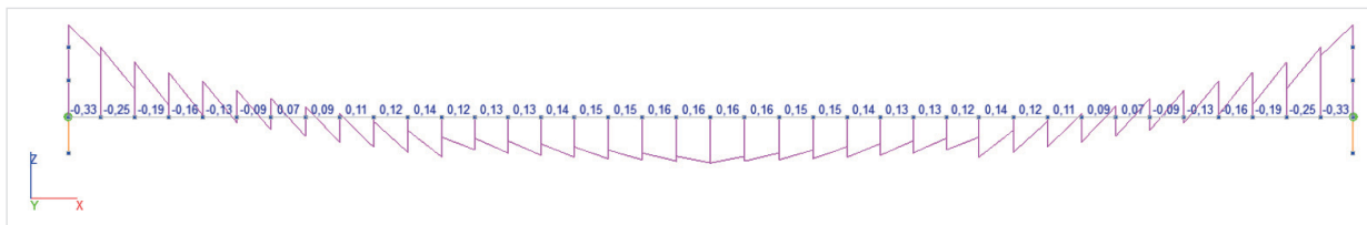
Рис. 9. Эпюра изгибающих моментов M_y [Тм] в короткой криволинейной балке B_1 от комбинации нагрузок C_2
