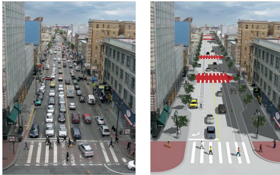
Рис. 2. Типовая схема дорожной диеты: реконфигурация 4-полосного поперечника в 3-полосный с выделением велоинфраструктуры (обобщённые данные FHWA)
