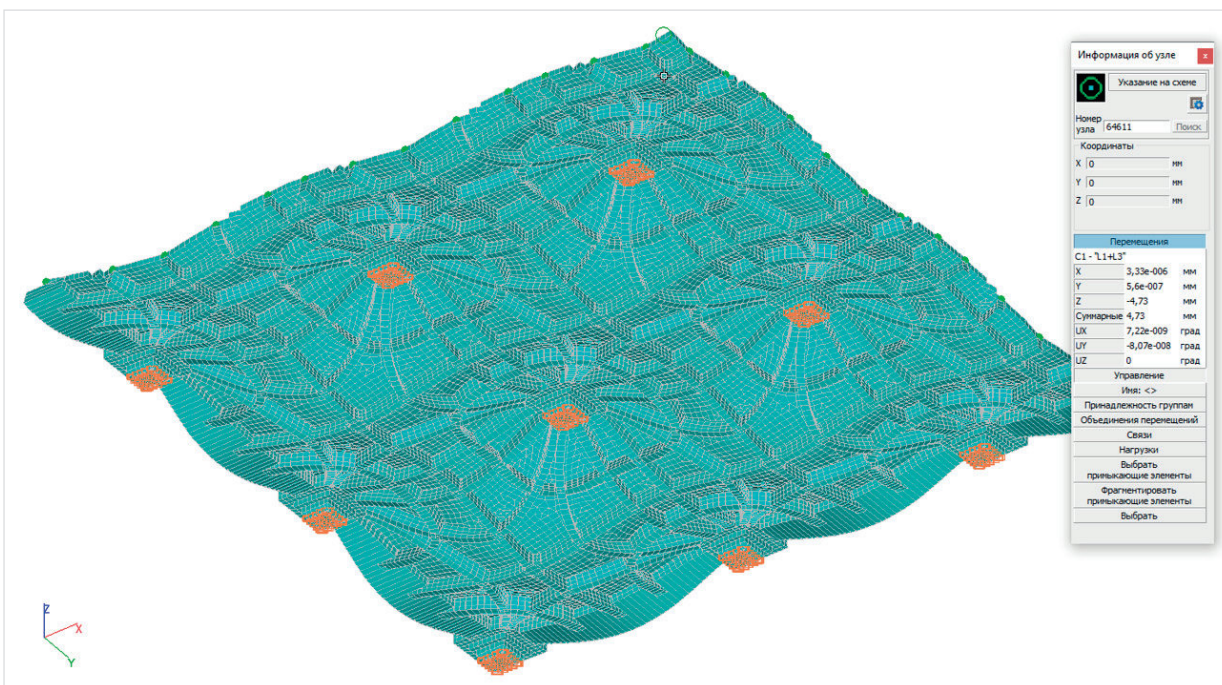
Рис. 1. Конечно-элементная модель покрытия, показана ¼ часть. Прогибы середины конструкции от действия полной нормативной нагрузки
