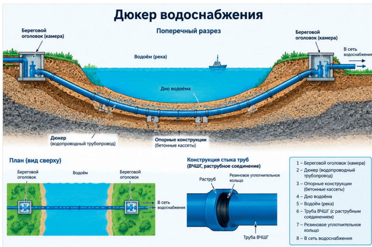
Рис. 1. Водопроводный дюкер
